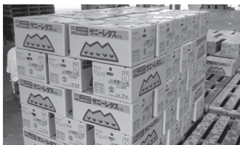
輸送試験中の新耐水段ボール
