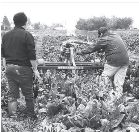
ホウレン草の根切収穫機試験
