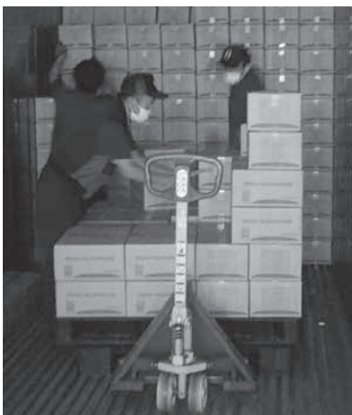
ハンドリフトを入れ商品を直積みする海上輸送コンテナ内の様子
