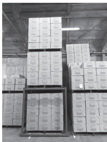
AK170 ライナーの倉庫での積み上げ試験
