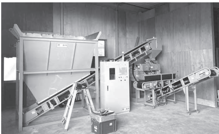
乾燥させた堆肥をペレット状に加工する「ペレットマシン」
