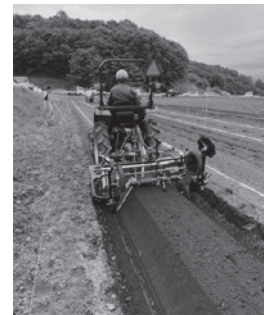
平高畝整形機（ベッドマイスター）施工の様子
